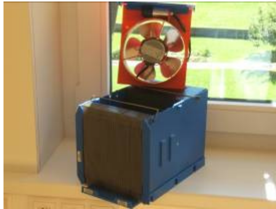
Abbildung 9.62: Lüftungsgerät in seine Bestandteile zerlegt
